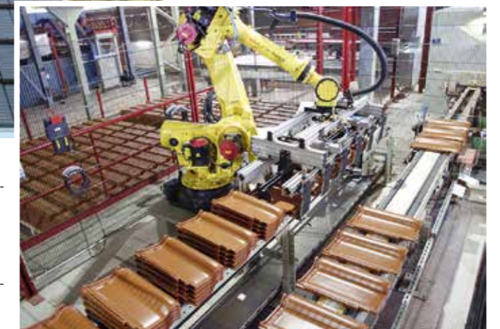
unten: Entladung der Dachziegel via Roboter.
